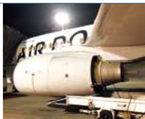
エンジン洗浄中の様子
